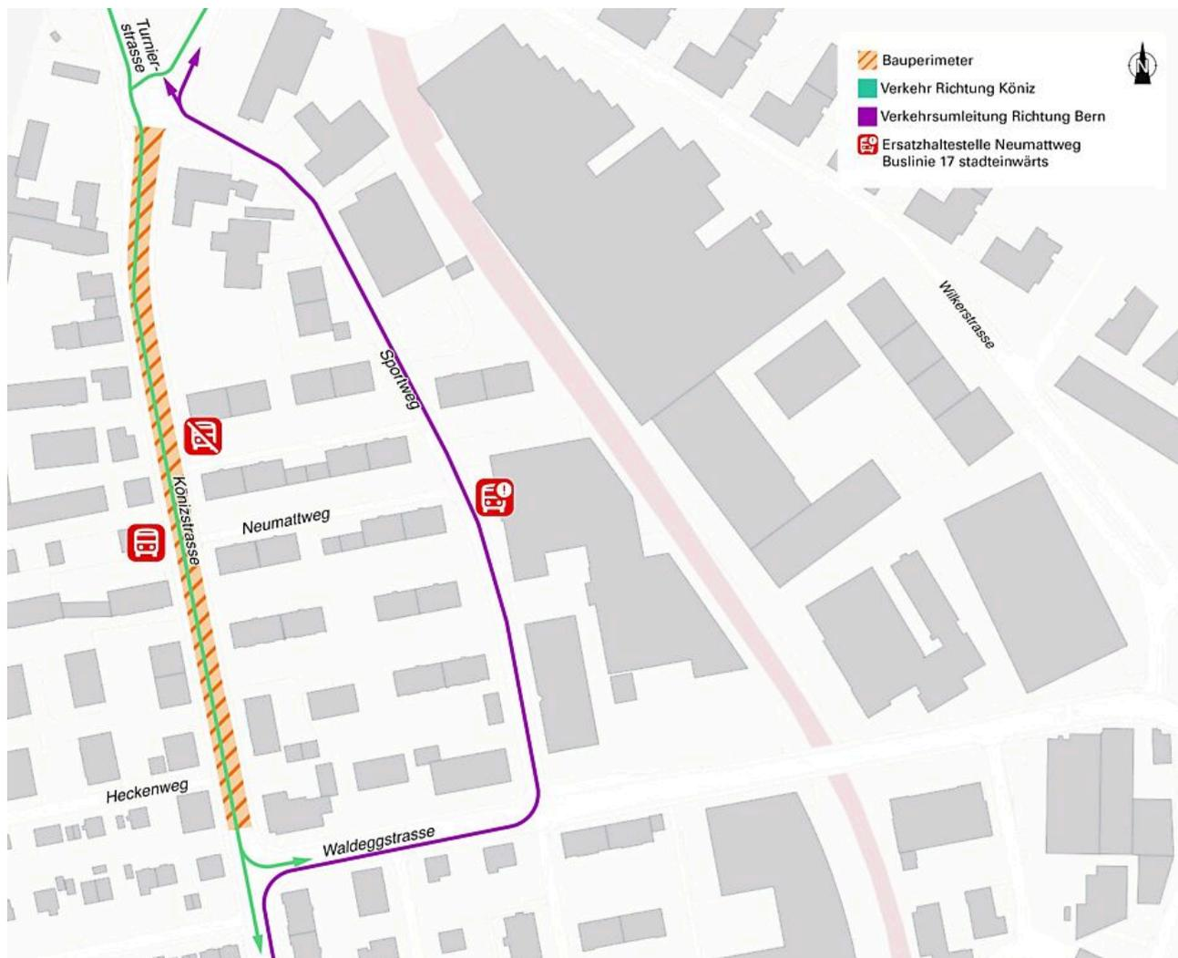
In der Könizstrasse müssen alte Werkleitungen für Wasser, Gas und Strom ersetzt werden. Gleichzeitig wird die Bushaltestelle Neumattweg hindernisfrei ausgestaltet. Der Arbeitsbereich beschränkt sich auf den Abschnitt zwischen der Waldeggstrasse und dem Kreislauf zur Turnierstrasse. Die Arbeiten starten am 11. März und dauern voraussichtlich bis Ende Juni 2024.
