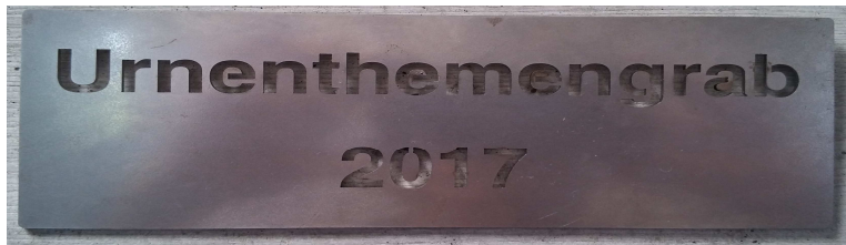
Masse: 20 cm x 8 cm, Material: Stahl, Ausschnitt mittels Schablone (vgl. Bild)
