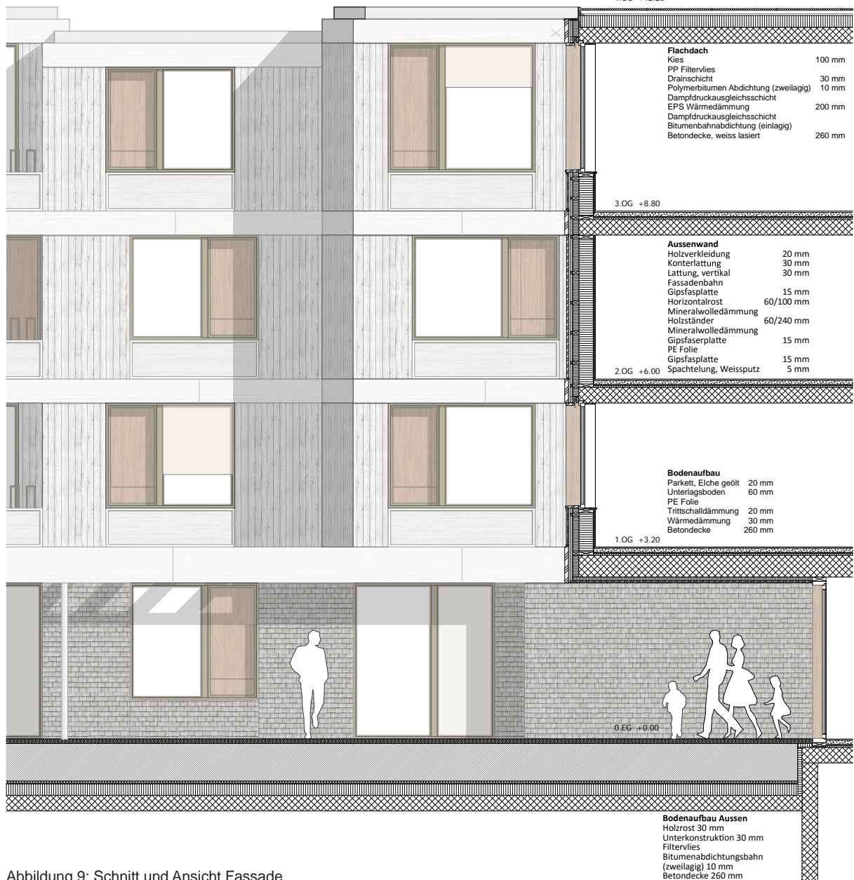
Abbildung 9: Schnitt und Ansicht Fassade
