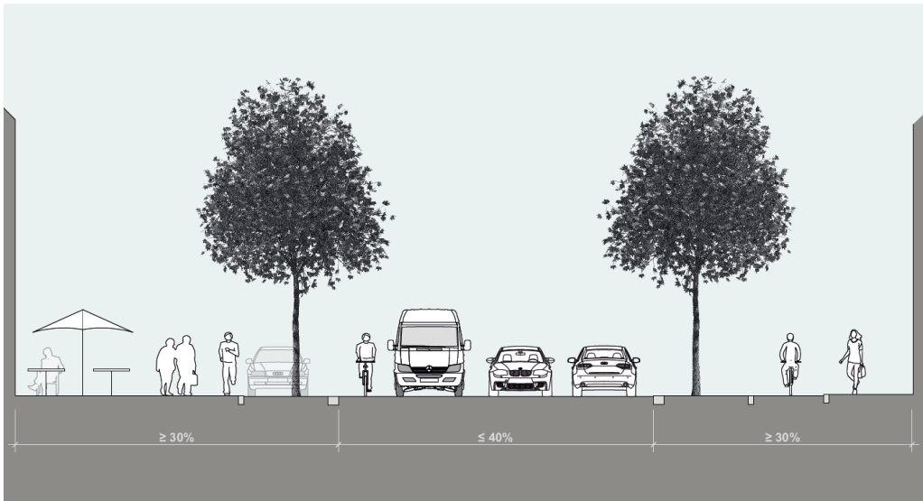
Abbildung 12: Beispielquerschnitt mit angenehmer Proportionierung
