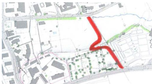
Abbildung 10: Variante 1: Bestehende Fussgänger Verbindung ausbauen / Länge 305 m
