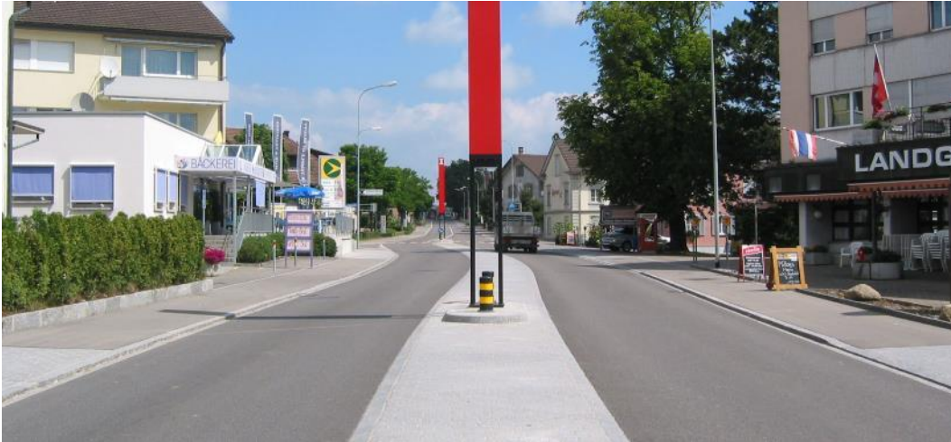
Abbildung 10: Abbildung eines möglichen Mehrzweckstreifens (Quelle: BFU «Strassenraumgestaltung»)
