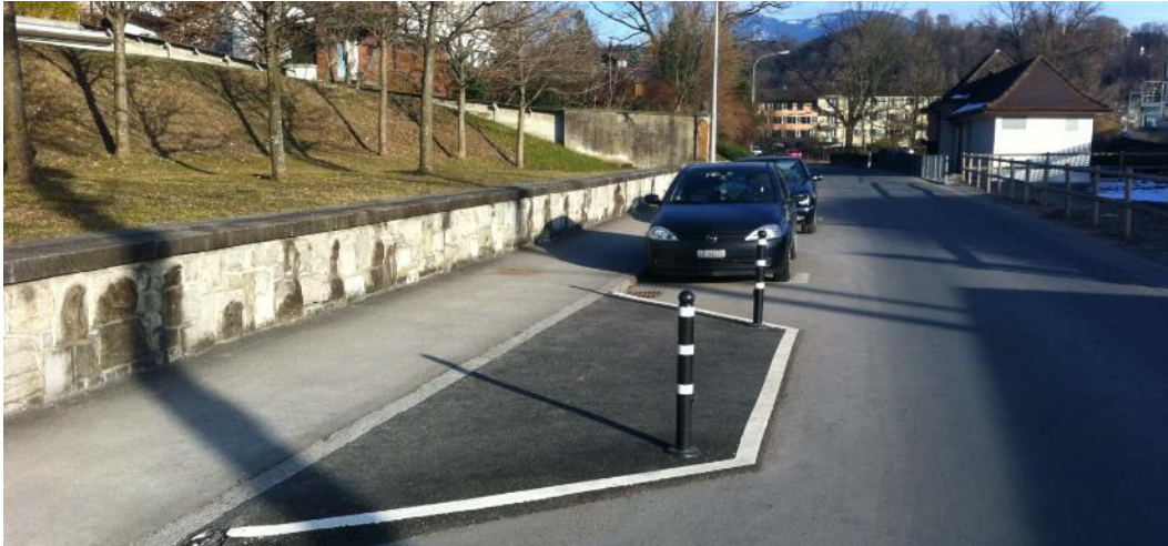
Abbildung 8: Vorgezogener Warteraum (Quelle: BFU «Strassenraumgestaltung»)
