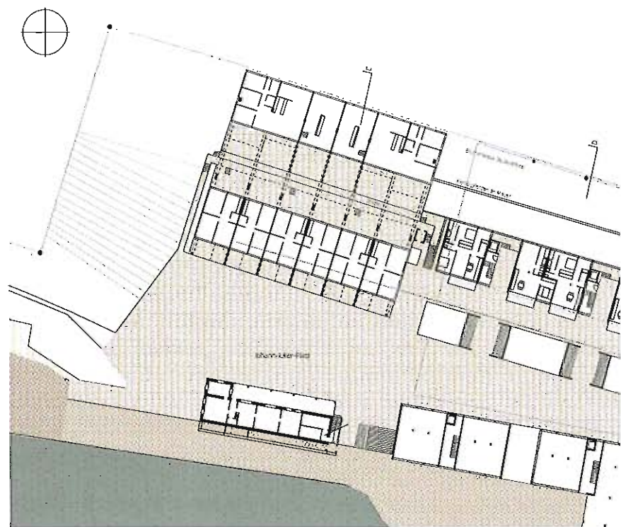
Grundriss Gebäude 37 umgenutzt _ 1:500
