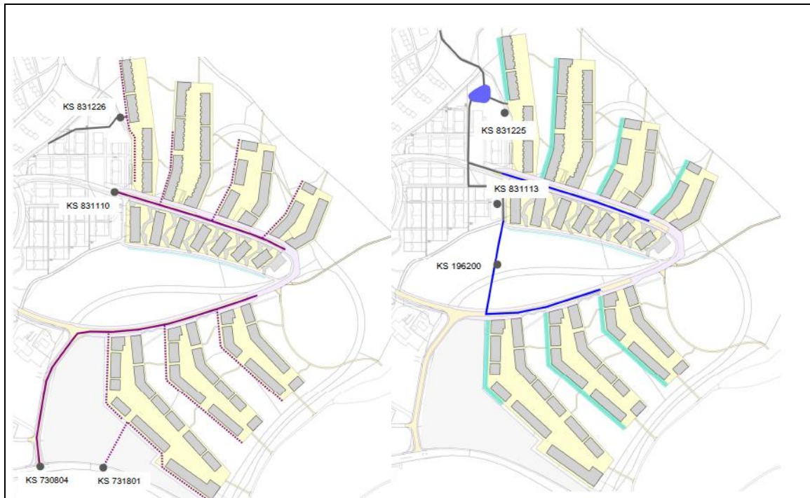
Abbildung 4: Öffentliche Erschliessung Abwasser (links: Mischabwasser, rechts: Regenabwasser)
